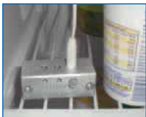
Aluminiumblock verzögert die Ansprechzeit des Fühlers
